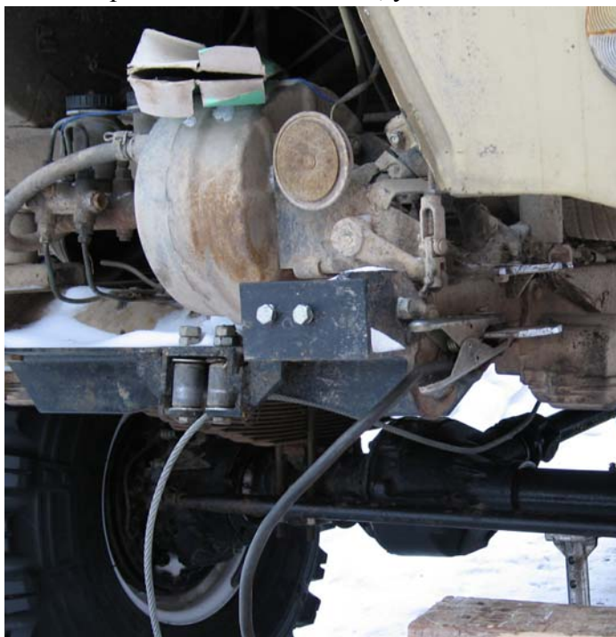
Рис. 31 Вид кронштейна крепления бампера к раме
