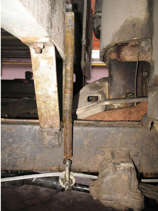
Рис. 28 Тросонатяжной роликовый узел
