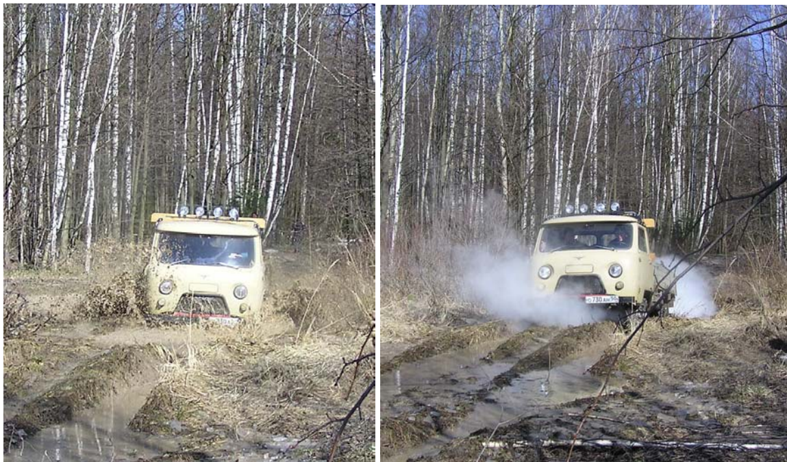
Рис. 2 УАЗверство-4. После этой лужи в карбюраторе были обнаружены следы воды. 2004г.
