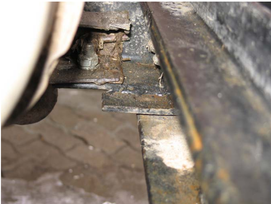
Рис. 33 Вид справа на крепление переднего бампера к левому лонжерону рамы
