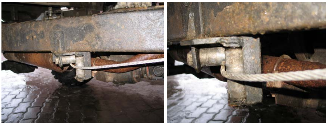
Рис. 27 Средний силовой роликовый узел
