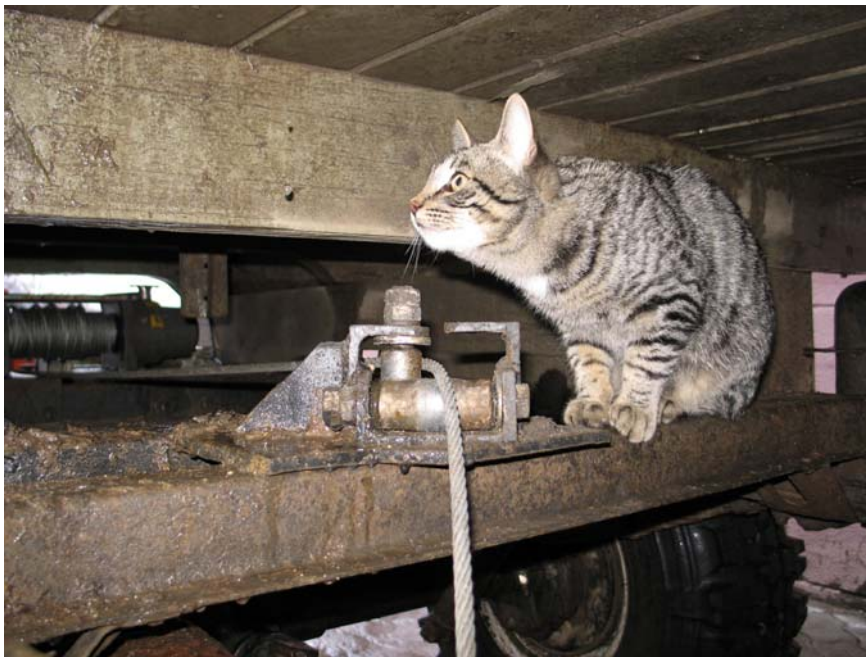
Рис. 26 Задний силовой роликовый узел. Совершенно случайно в кадр попал главный механик.
