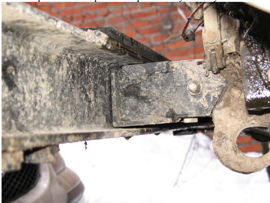
Рис. 32 Вид слева на кронштейн крепления переднего бампера к раме
