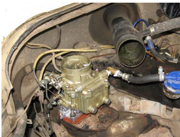
Рис. 22 Та же труба шноркеля, но уже в подкапотном пространстве (вид справа и слева). Гофра на карбюратор не надета. Также на этих фото труба еще не разрезана и в нее не вставлена дополнительная гофра.
