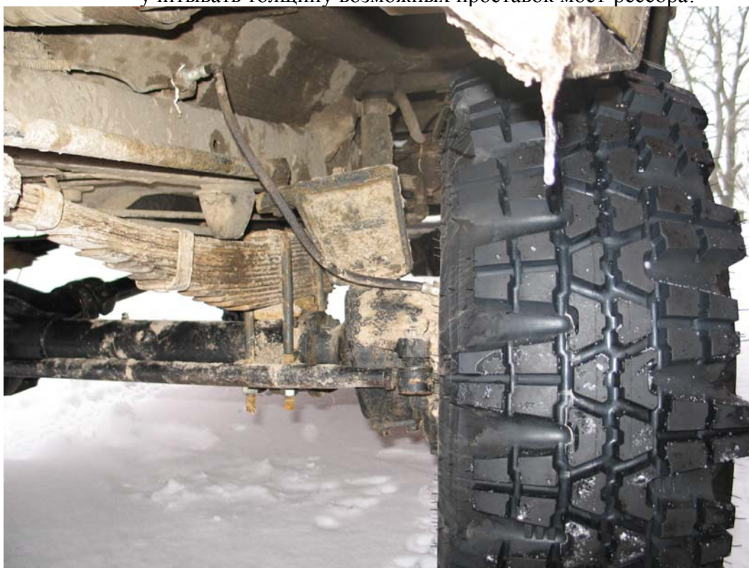
Рис. 24 Рулевой рычаг военных мостов
