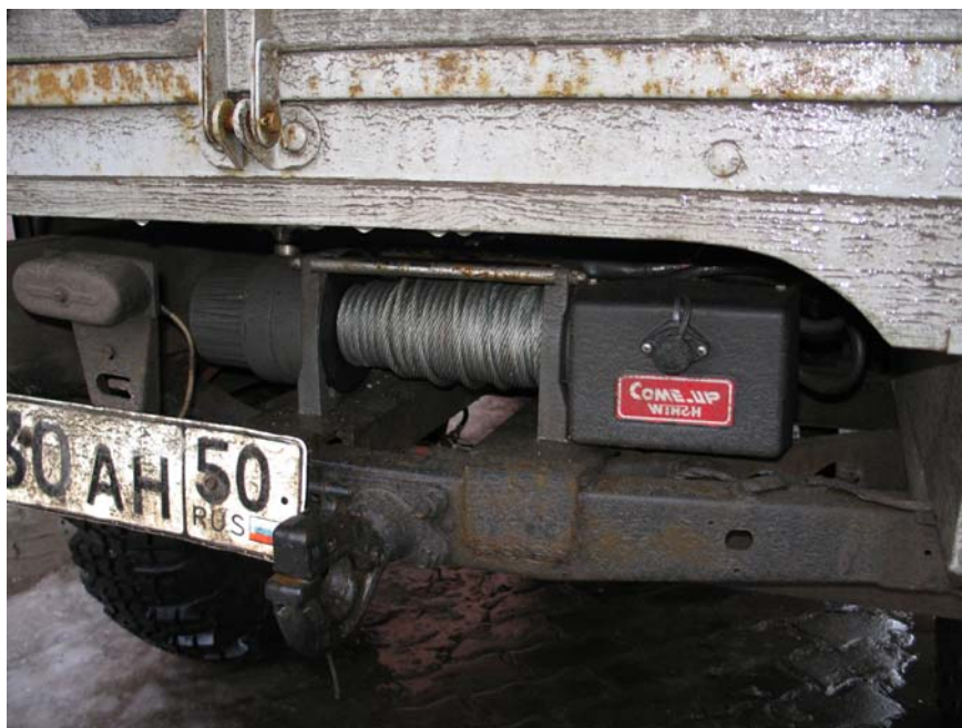
Рис. 25 Вид на лебедку и опорные площадки лебедки сзади
