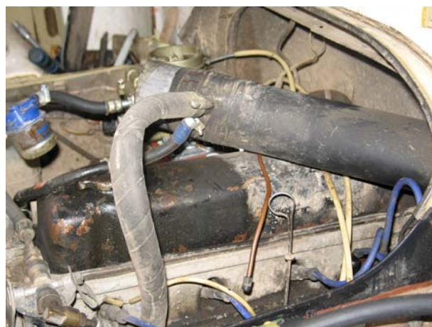
Рис. 22 Та же труба шноркеля, но уже в подкапотном пространстве (вид справа и слева). Гофра на карбюратор не надета. Также на этих фото труба еще не разрезана и в нее не вставлена дополнительная гофра.
