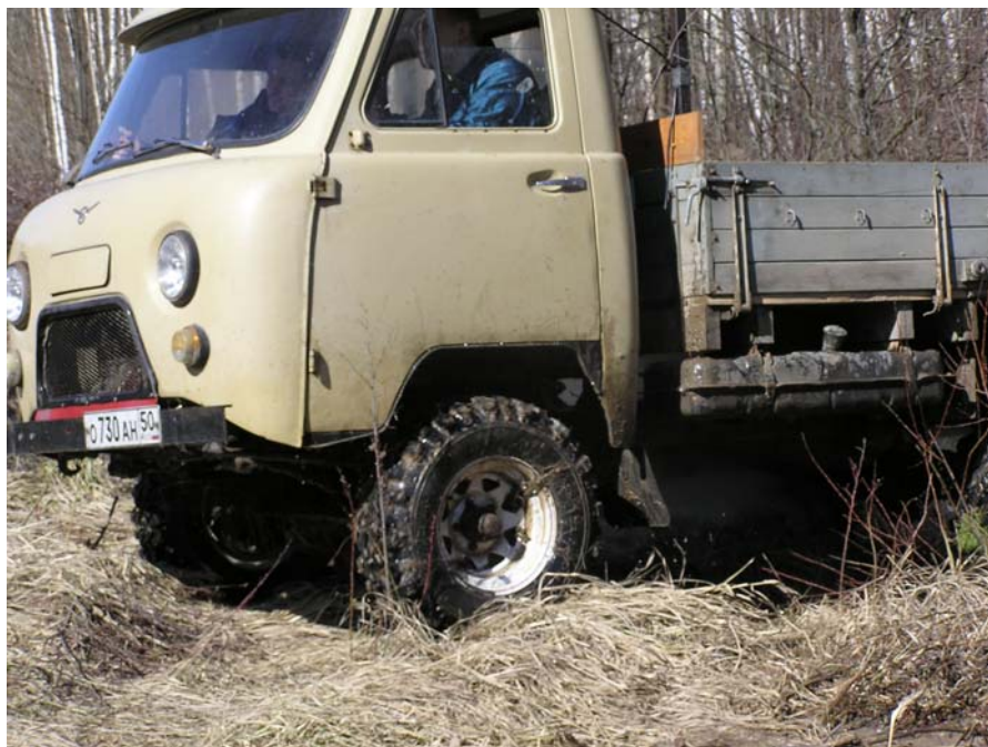
Рис. 8 Вид на подрезанную кромку арки
