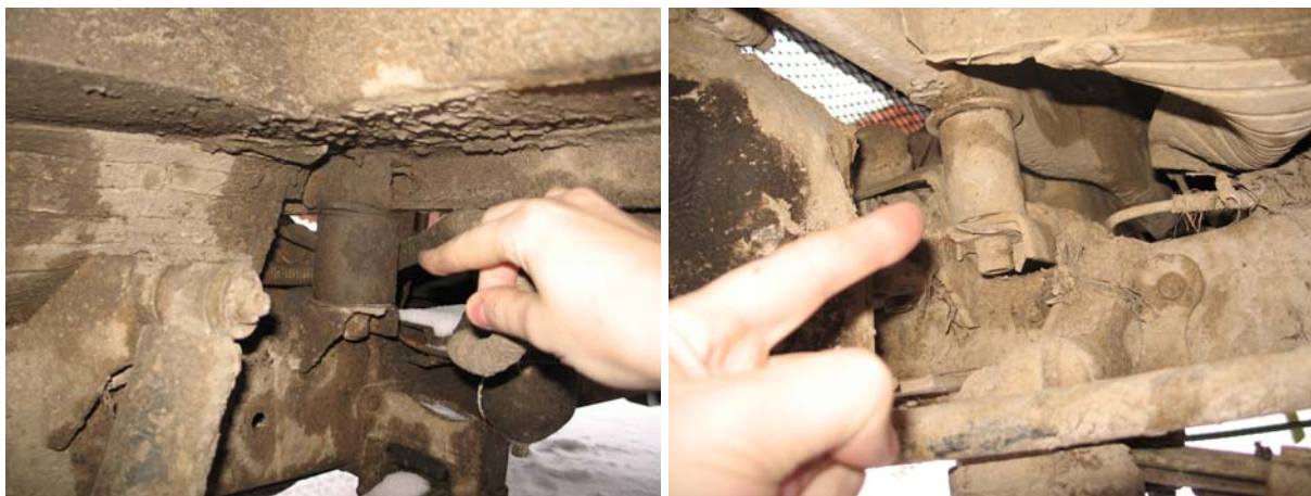
Рис. 13 Вид на проставки под задние (фото слева) и передние (фото справа) опоры кабины
